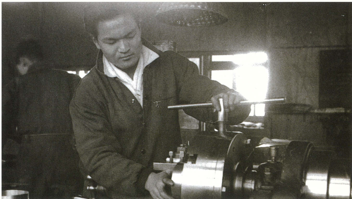
軸受用レースの旋削作業に精を出す窪田。新町工場にて [昭和31年]
