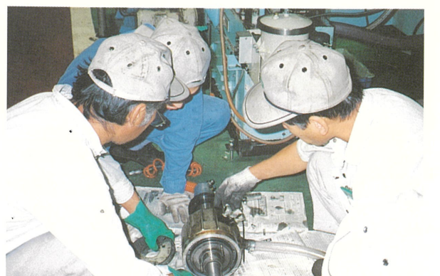
回転シリンダー分解修理O.J.Tによりスキルアップを図る
