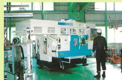
平成12年 (2000年) ガントリーローダー付2スピンドルCNC複合旋盤 (写真1)
