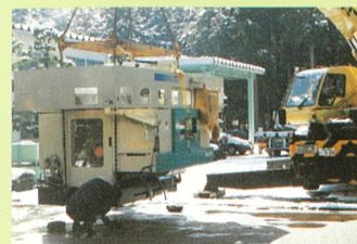
平成3年 (1991年) ガントリーローダー付2スピンドルCNC旋盤 (写真2)
